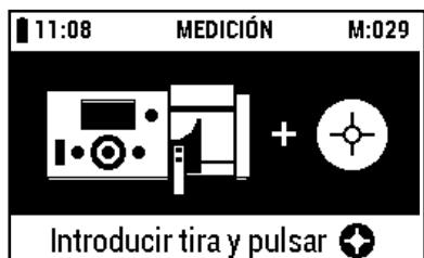
Inserte la tira de ensayo en el adaptador de tiras de ensayo y pulse el botón [START (inicio medición)].
