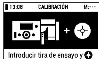
Inserte la tira de calibración del equipo de recalibración (forma parte del volumen de entrega del RQflex® 20) en el adaptador de tiras con el borde oblicuo mirando hacia fuera y arriba, y pulse el botón [START (inicio medición)].
