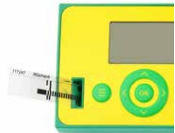
Inserte la tira de ensayo para RQcheck en el adaptador de tiras de ensayo y pulse el botón [START (inicio medición)].
