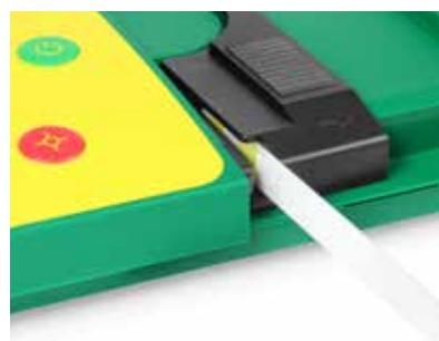
La medición comienza automáticamente después de acabar el tiempo de reacción.
