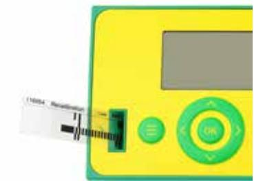
Asegúrese de que ninguna tira de ensayo esté insertada en el adaptador de tiras de ensayo y, a continuación, pulse [OK].
