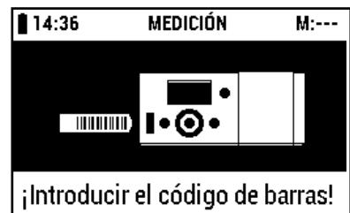
Retire la tira específica de código de barras del envase de Reflectoquant®. Algunos tests requieren dos tiras de código de barras.
