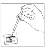
2 Moisten Anaerocult® C mini with 3 ml of water (Fig. 2).
